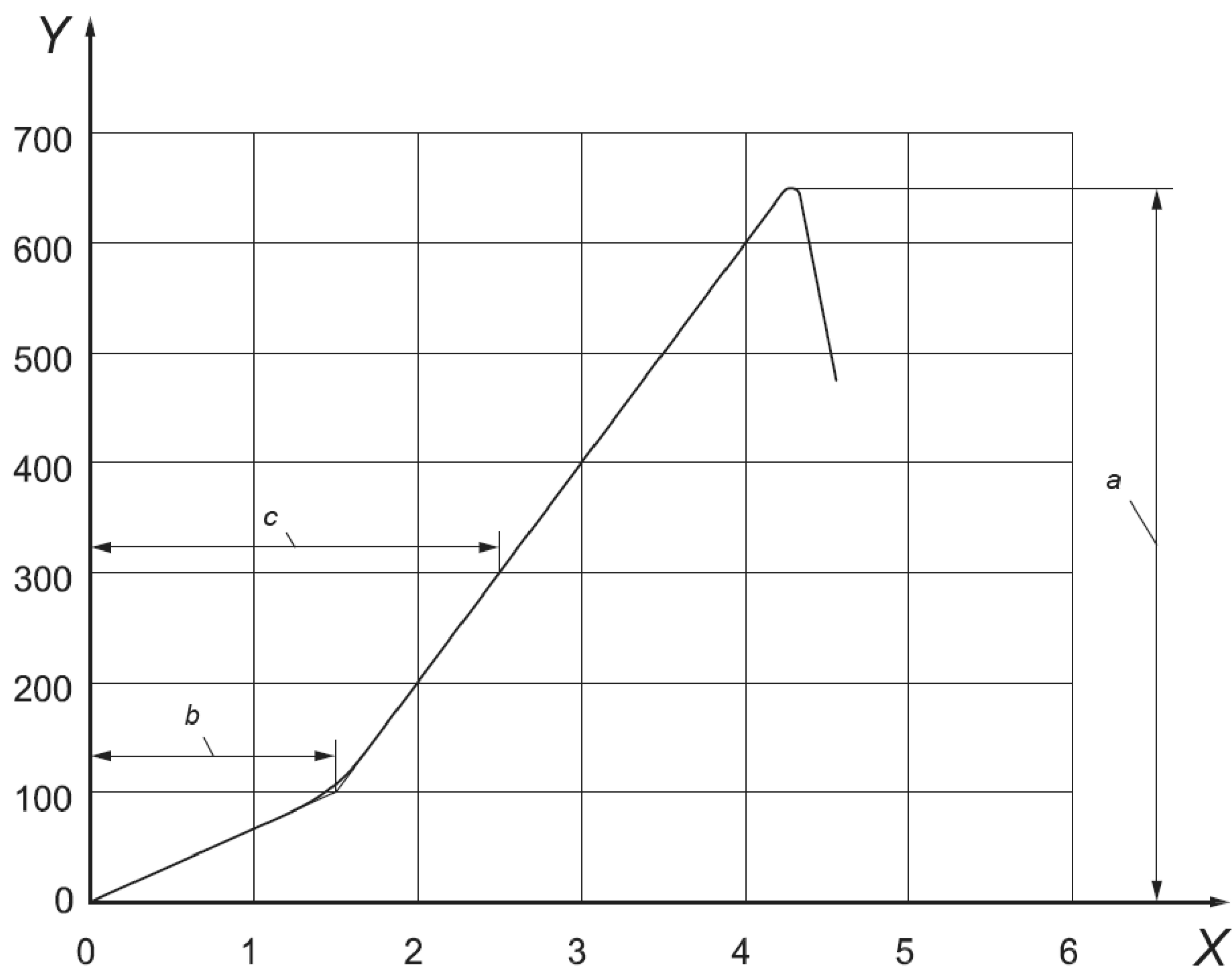
X — удлинение, %; Y — усилие растяжения, Н; а — усилие растяжения в момент разрыва волокна;
