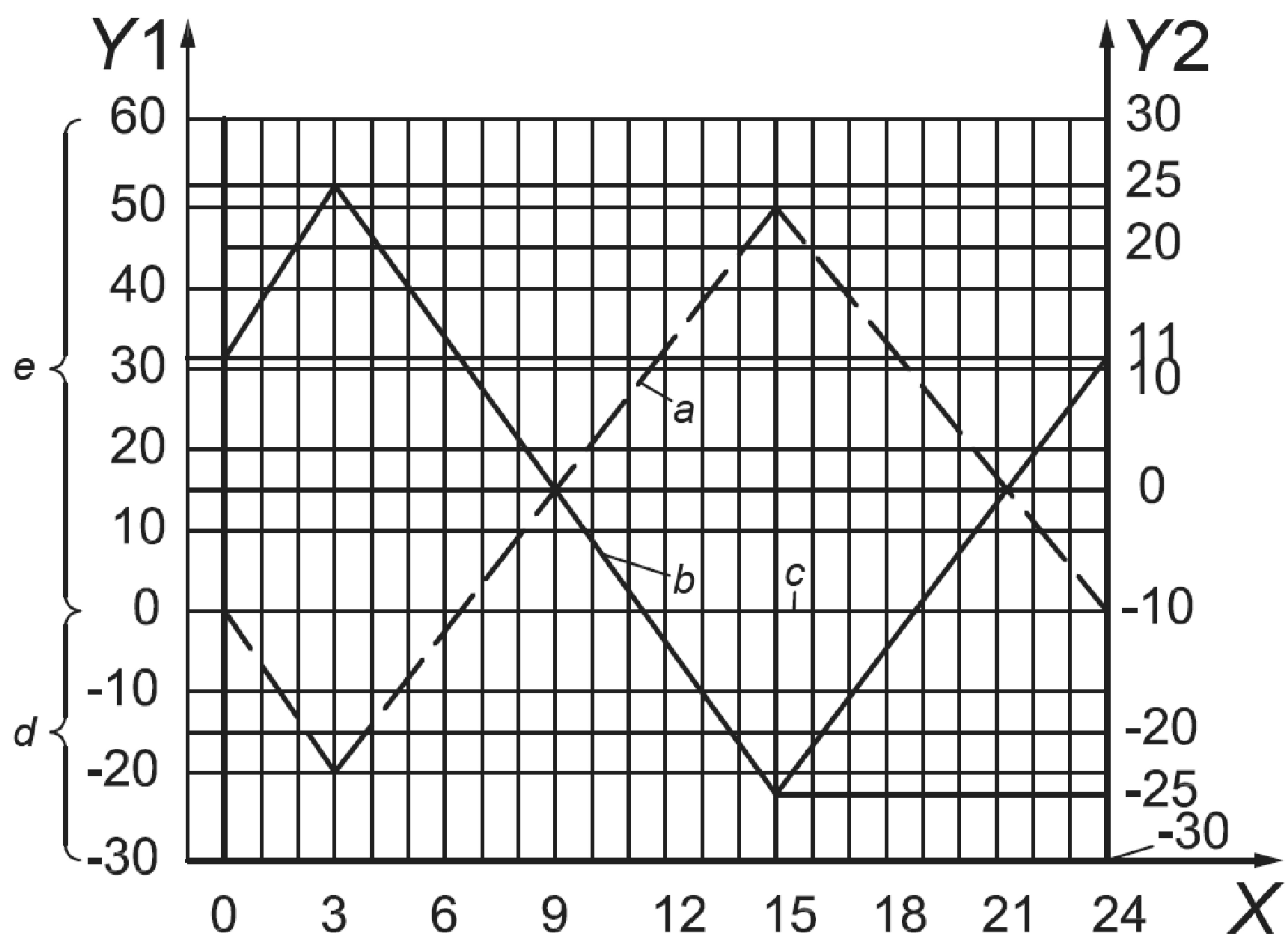
$X$  — время, ч;  $Y_1$  — степень сжатия уплотнения (см. В.4.1.5);  $Y_2$  — температура,  $^{\circ}\text{C}$ ;
