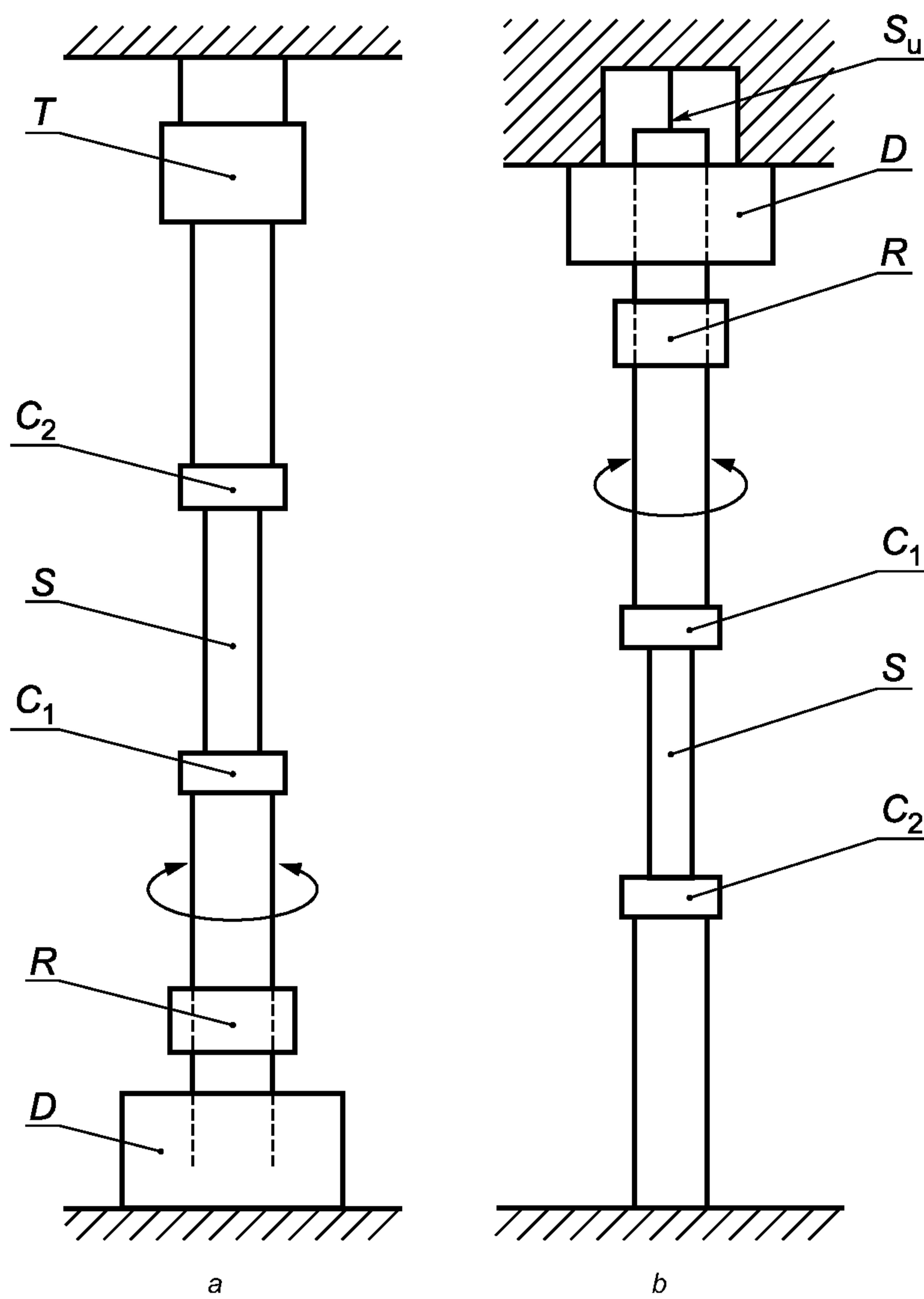
*T* — датчик крутящего момента; *C<sub>1</sub>*, *C<sub>2</sub>* — зажимы; *S* — образец для испытания; *R* — датчик углового смещения; *D* — приводное устройство; *S<sub>u</sub>* — подвеска
