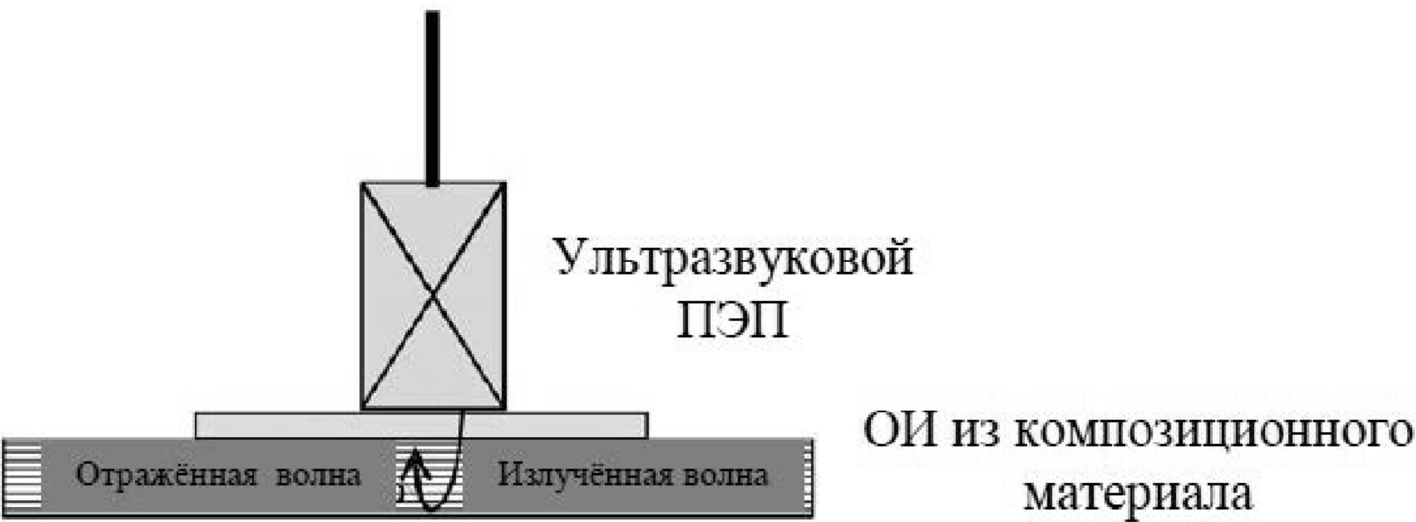
Рисунок 1 — Метод А. Автоматизированный ультразвуковой эхо-импульсный метод
