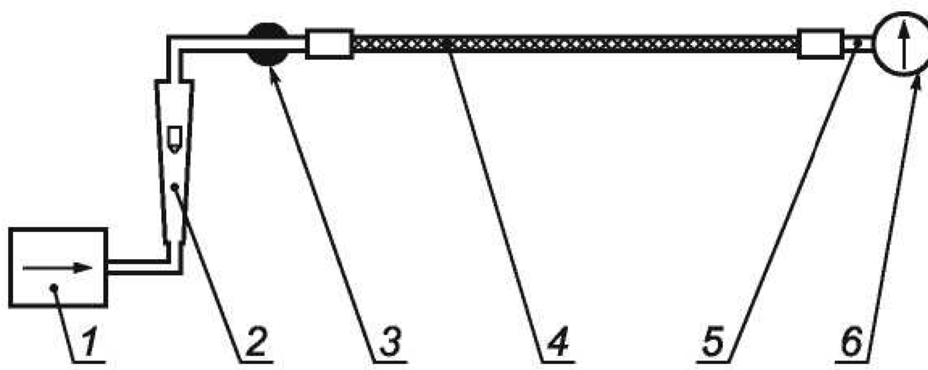
1 - регулируемый источник сжатого газа; 2 - ротаметр; 3 - кран; 4 - проверяемый шланг; 5 - переходник к манометру; 6 – манометр
