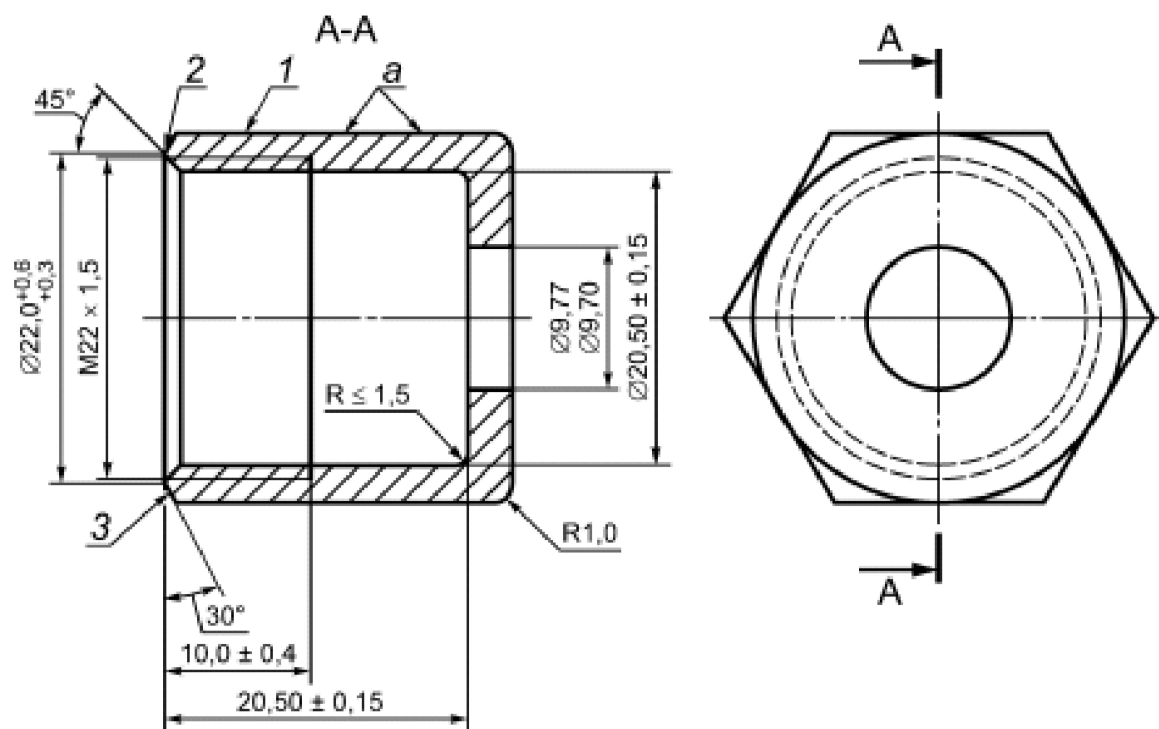
1 - только для идентификации гаек с левой резьбой применяется паз V-образного сечения на ребрах шестигранника на глубину до плоскостей граней;
